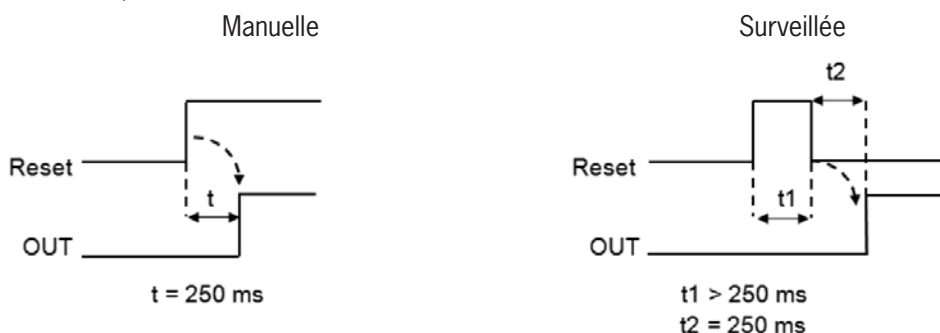
Fig. 142 : Réinitialisation manuelle / surveillée de l'interrupteur
