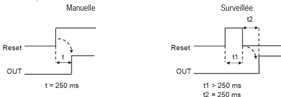
Fig. 119 : Réinitialisation manuelle / surveillée du verrouillage simple canal
