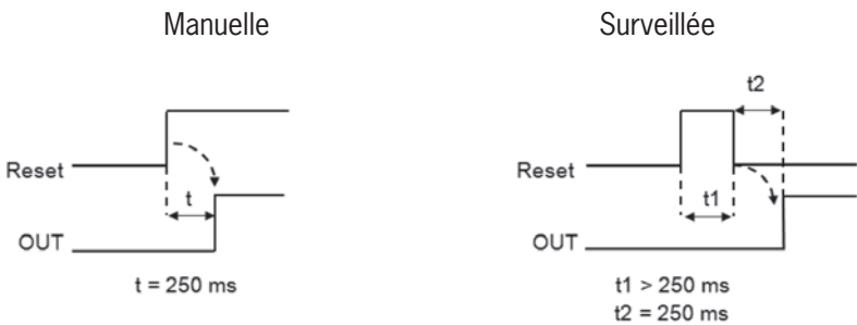
Fig. 116 : Réinitialisation manuelle / surveillée du verrouillage
