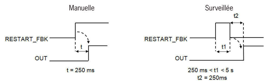
Fig. 12 : Redémarrage manuel / surveillé
