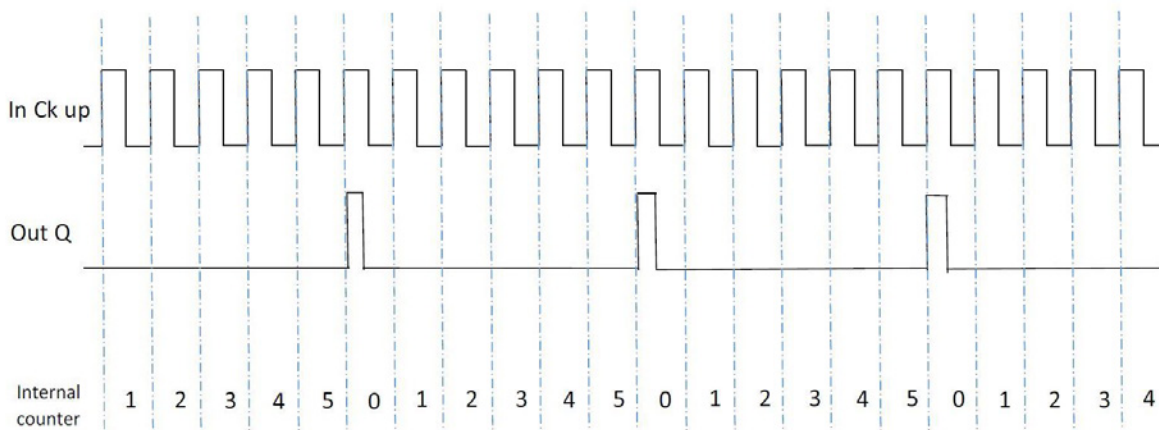
Fig. 222 : Utilisation du compteur sans entrée de réinitialisation
