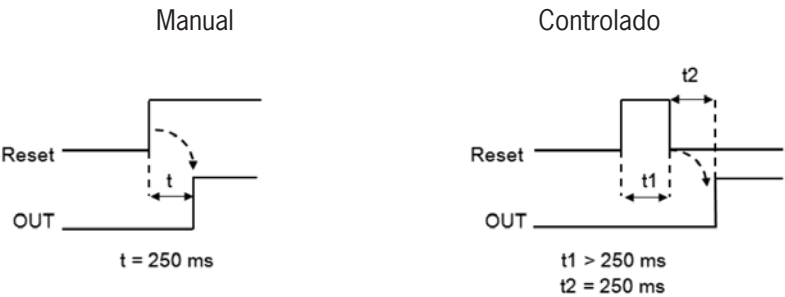
Fig. 132: Restablecimiento manual/controlado de una barrera óptica
