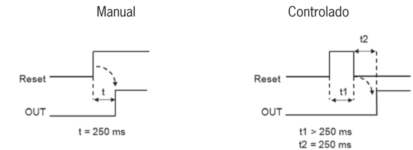
Fig. 116: Restablecimiento manual/controlado de un enclavamiento
