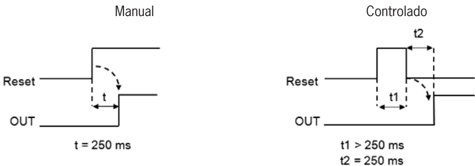
Fig. 150: Restablecimiento manual/controlado de una salida de semiconductor
