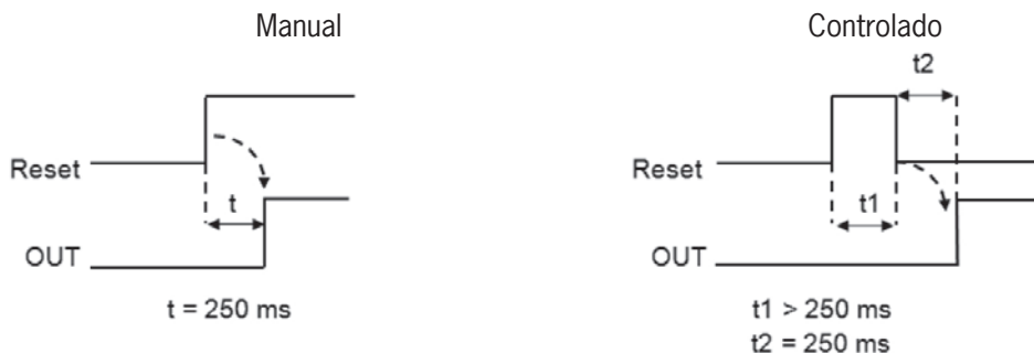
Fig. 119: Enclavamiento monocanal con restablecimiento manual/controlado
