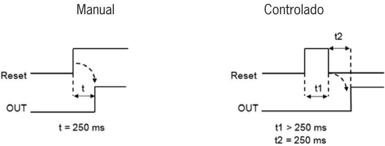
Fig. 125: Restablecimiento manual/controlado de un equipo de protección electrosensible (ESPE)
