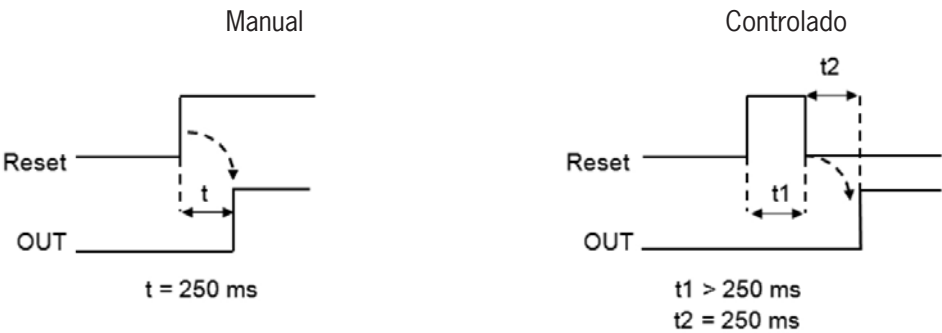
Fig. 220: Restablecimiento manual/controlado de la lógica de bloqueo
