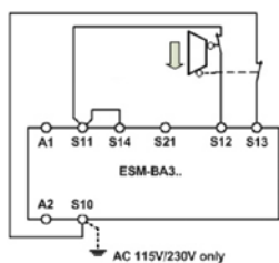
Fig. 5: Circuito de parada de emergencia de doble canal con control de errores de conexión cruzada y cortocircuitos a masa (categoría 4, hasta PL e).
