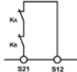
그림 14: 자동 시작 기능이 포함된 피드백 루프. 외부 연결 접촉기 또는 접점 확장부의 모니터링
