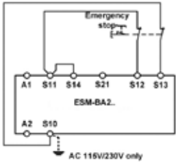
그림 5: 단락 회로 및 접지 고장 모니터링 장치가 장착된 듀얼 채널 비상정지 회로(범주 4, 최대 PL e).
