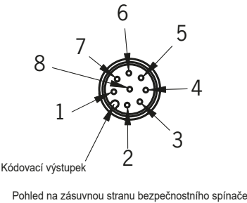
Obr. 2: Obsazení konektoru bezpečnostního spínače CES-AR
