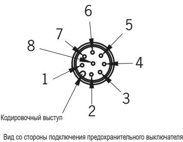
Рис. 2. Схема контактов штекерного соединителя предохранительного выключателя CES-AR-C01
