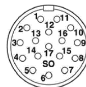
Polbild Buchsenstecker mit Außengewinde 19-polig Ansicht auf Steckseite
